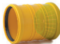
KDR 12 przyłącze drenarskie uniwersalne zewnętrzne łączy rury drenarskie od \varnothing 72 do \varnothing 100 mm z bosym końcem rury odpływowej \varnothing 110 mm
