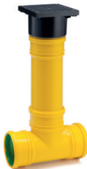
KDR 30 rewizja drenarska uniwersalna z rurą wznoszącą \varnothing 110 x 500 łączy rury drenarskie od \varnothing 72 do \varnothing 100 ułatwia kontrolę zanieczyszczenia lub zamulenia instalacji drenarskiej
