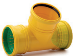
KDR 26 trójnik drenarski uniwersalny z przyłączem bocznym \varnothing 110 łączy rury drenarskie od \varnothing 72 do \varnothing 100 mm z rurą litą \varnothing 110
